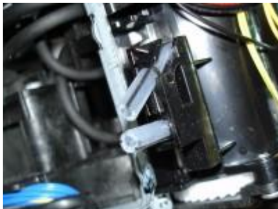
⊕ Durch diese Schläuche der Reinigungseinheit an der Unterseite des Druckwerks gelangt die Tinte in die Resttintenschwämme.
