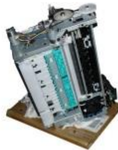
⊕ Es empfiehlt sich, das Druckwerk senkrecht auf eine dicke Lage Zeitungen, einen alten Karton oder Ähnliches zu stellen, um eine Sauerei zu vermeiden.
