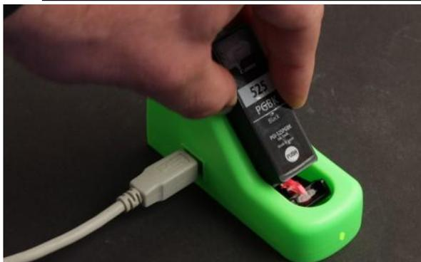
Le RESETER permet de reprogrammer la puce et ainsi de retrouver le contrôle du niveau d'encre.
